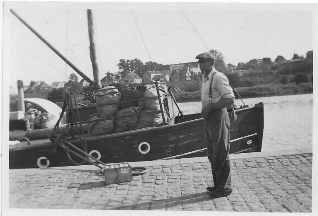
Her ses hvordan der blev plads til ekstra gods ude i skibssiderne. På kajen Hans Heinsvig. Foto: H.P. Hansen
